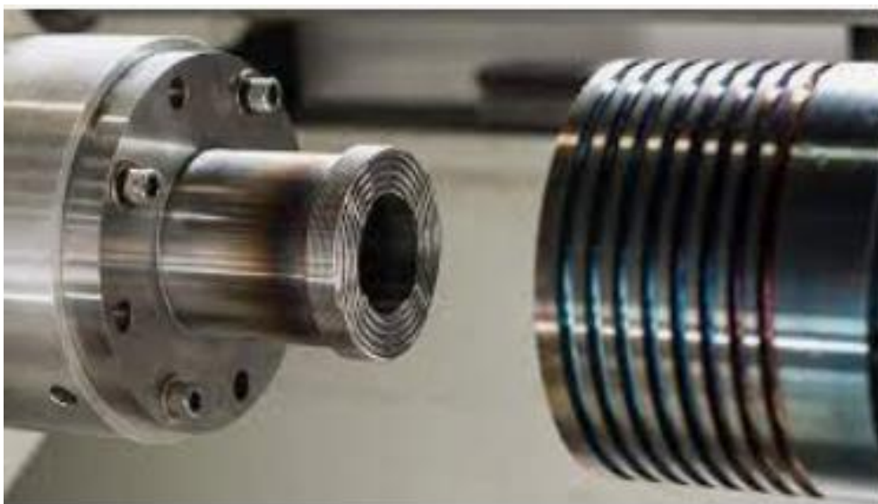
Figura 5: Modelo de matriz de aço utilizado na prensa de extrusão (“ press machine ”)
