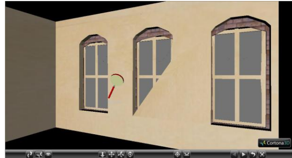
Figura 4. Problemas no nó indexedFaceSet, distorcendo a aplicação da textura da parede interna.
