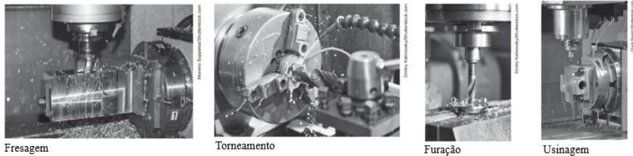
Figura 2 - Etapas de fabricação de moldes e matrizes em máquinas CNC (Manufatura Subtrativa)
