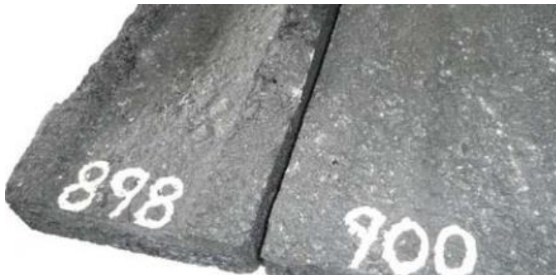
Figura 2 – Placas após simulador LCPC (laboratório).
