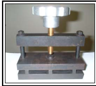
Fotografia 7: Prensa utilizada no ensaio de deformação permanente sob compressão.
