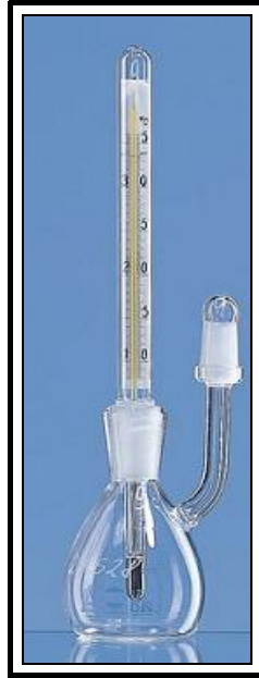
Fotografia 4: Picnômetro utilizado no ensaio de determinação da densidade da barita.
