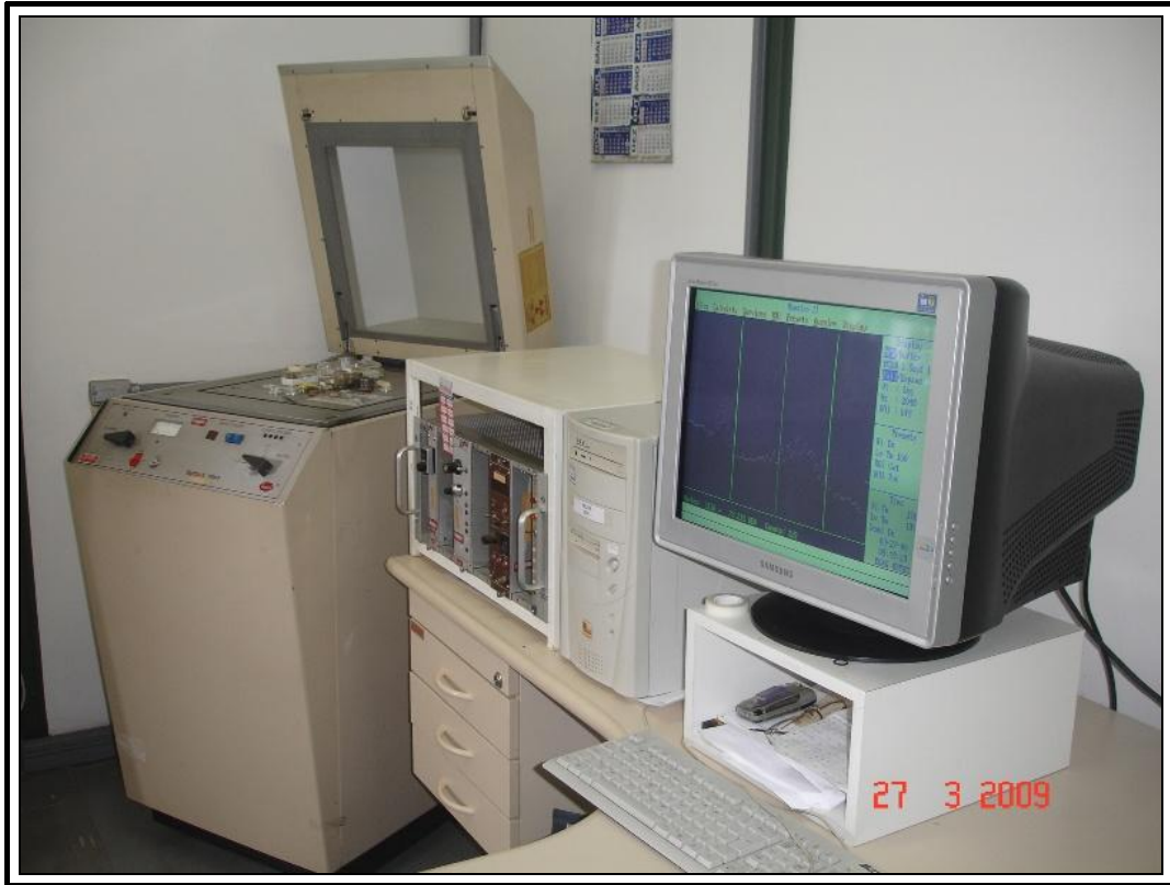
Fotografia 5: Espectrômetro sistema KeveX utilizado na espectrometria por fluorescência de raios X.
