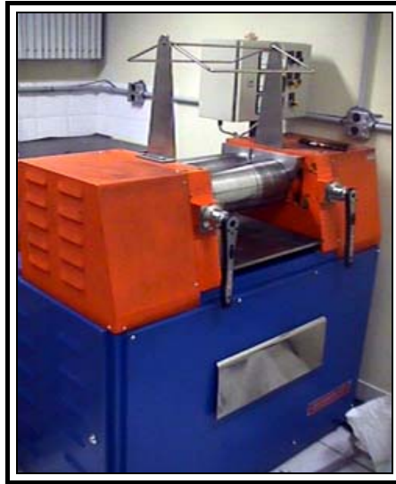
Fotografia 2: Calandra Mecanoplast usada na obtenção das amostras.
