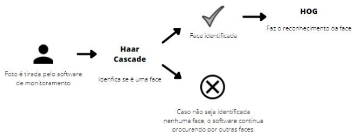
Figura 7 - Fluxograma de funcionamento do reconhecimento facial. Fonte: elaborado pelos autores (2021).
